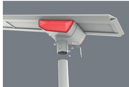
(2) Leuchte ausrichten und die 6 Schrauben fest anziehen
